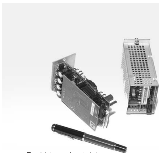
Te miniaturowe konstrukcje to wzmacniacze cyfrowe o mocy 520 W rms
